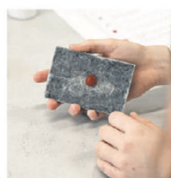
Wasser oder Ketchup perlen auf dem Aerogel-Pulver und der Aerogel-Matte ab.
