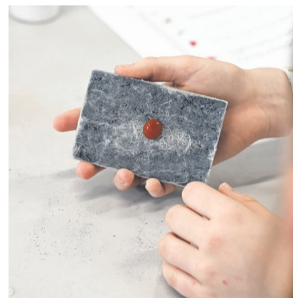
Wasser oder Ketchup perlen auf dem Aerogel-Pulver und der Aerogel-Matte ab.
